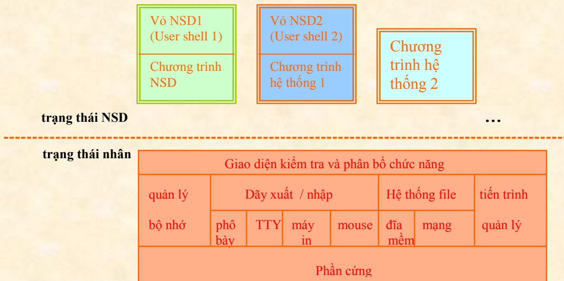
Hình 1.6. Các lớp của hệ điều hành Unix
